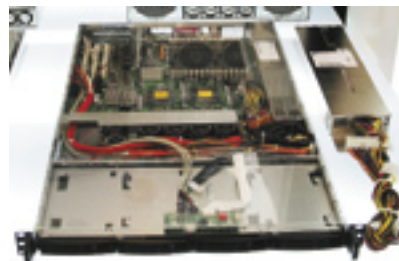
Корпус Chenbro RM13204 высотой 1U, предназначенный для создания серверов, устанавливаемых в стандартную стойку
